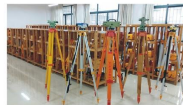
普通测量实验室（水准仪、自动安平水准仪、DS05精密水准仪、Z6经纬仪、自动安平水准仪）
