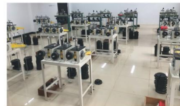
岩土工程实验室（固结）
